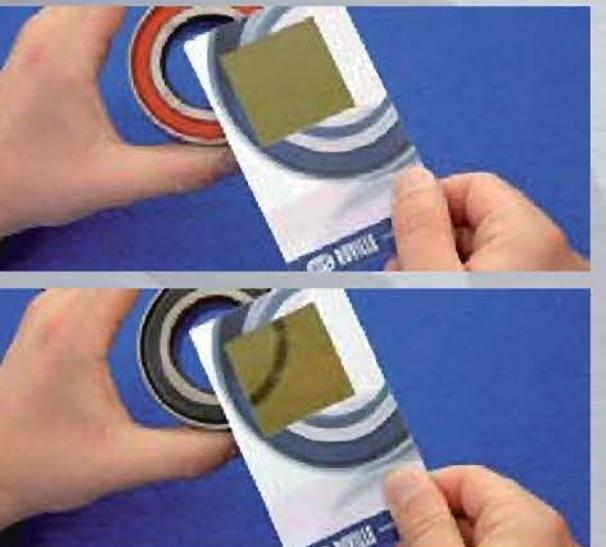
Použití detektorové karty na příkladu ložiska se senzorem na spodním obrázku
