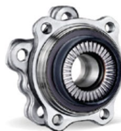
Ložisko kola s ECO-Hub prírubou optimalizovanou podľa hmotnosti
